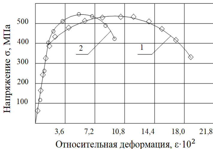
Рисунок 5. Диаграмма растяжения образцов стали 10ГН2МФА на воздухе и в дистиллированной воде при температуре 280 °С и скорости
