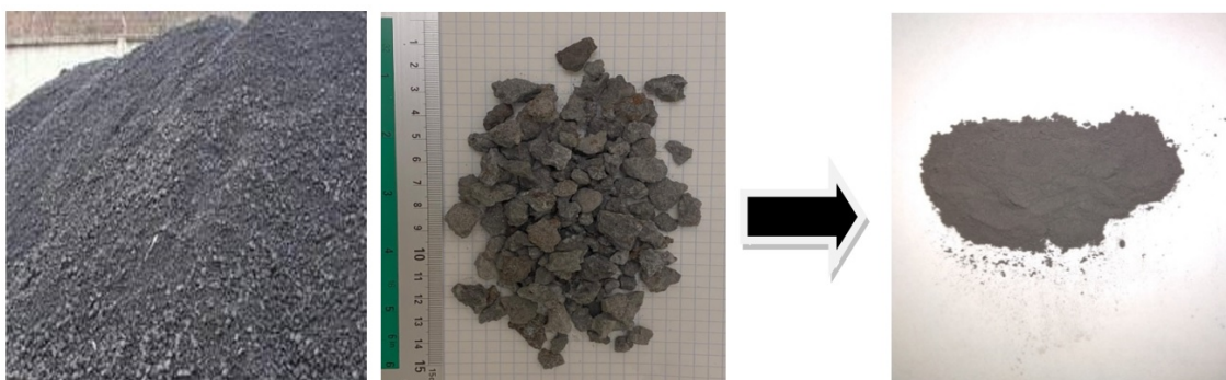
Рисунок 1 – Измельченный сталеплавильный шлак для применения в цементном производстве
