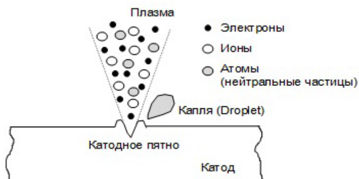
Рисунок 2 - Схема формирования микрокапельной составляющей паро-ионного потока для процесса КИБ [8]
