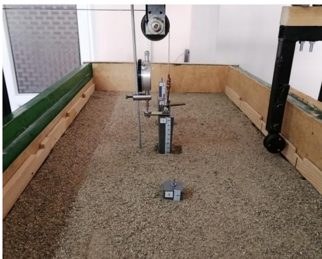
Рисунок 1. Схемы моделей свай (а) и фрагменты их испытаний (б)
