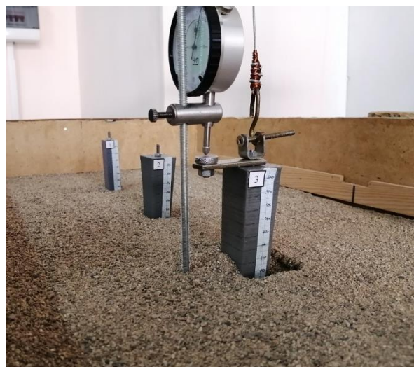
Рисунок 1. Схемы моделей свай (а) и фрагменты их испытаний (б)
