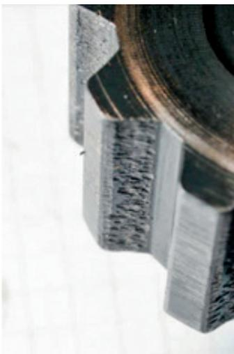
Рисунок 5. Износ шестерни насоса
