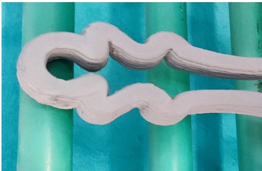
1-сурет. «Құрылыс 3D принтерінде қабатты экструзия өнімін жасау» [7]
