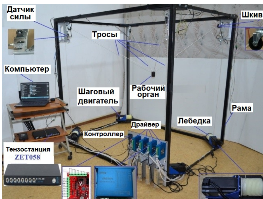
Рисунок 4 – Прототип подвешенного точечного ТПР
