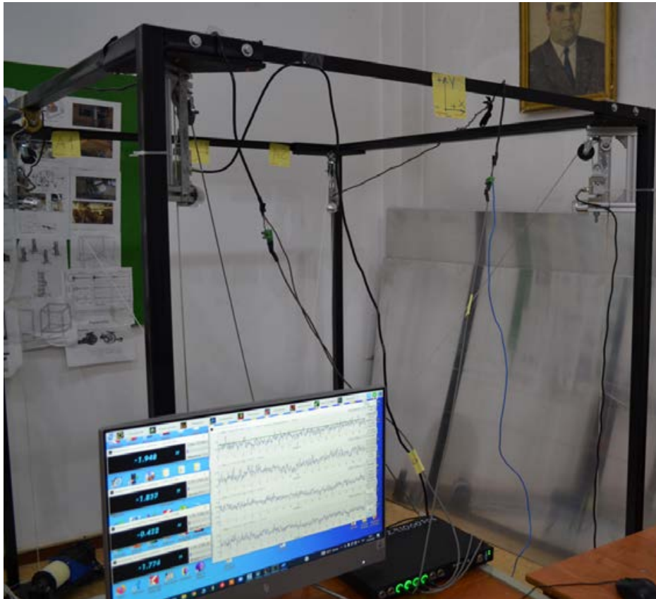
Рисунок 6. Тензометрическая измерительная система ZET 058
