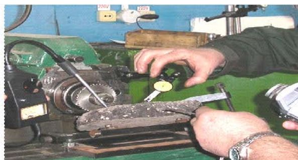
Рисунок 2. Измерение виброакустических колебаний в процессе резания с помощью виброизмерительной системы (США)
