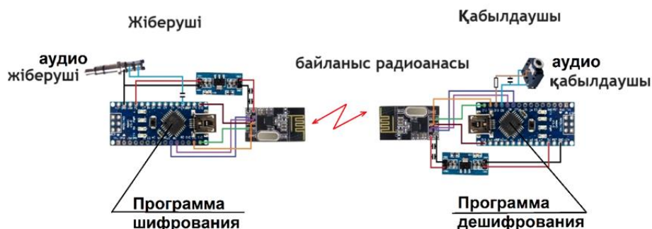
4-сурет. Аудиодеректерді криптографиялық қорғауды жүзеге асырудың мысалы: Arduino микроконтроллер платформасына негізделген
