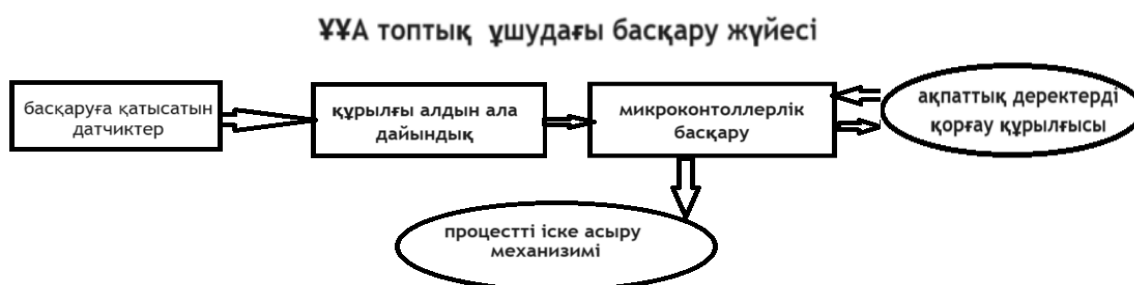
3-сурет. ҰҰА басқару жүйесінің негізгі жұмыс жасау принципі
