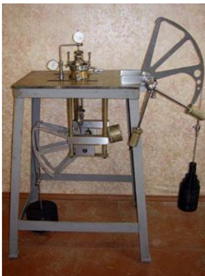
1-сурет. Кесу жазықтығы бекітілген Гидрожоба модификациясындағы Маслов-Лурье бір жазықтықты кесу аспабы
