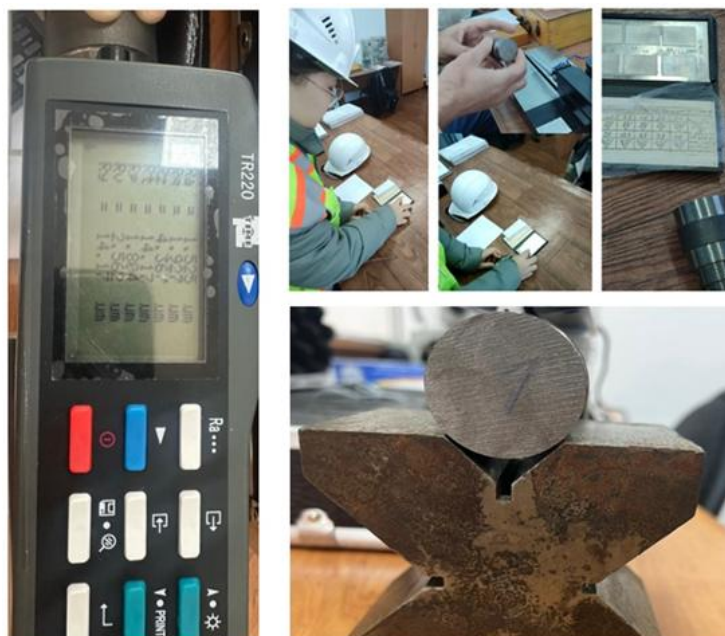
4-сурет. TR220 портативті өлшегіштегі беттің кедір-бұдырын өлшеу
