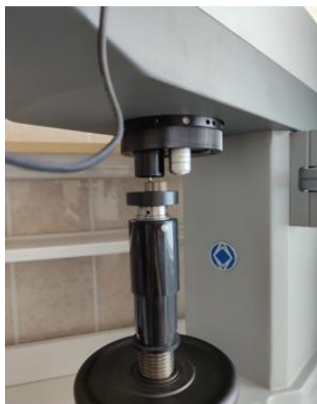
6-сурет. Қаттылық өлшейтін Wilson VH1150 құрылғысында қаттылықты өлшеу
