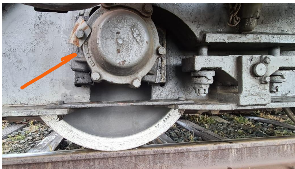
6-сурет. Темір жол кранының жүріс арбаларындағы саңылау пластиналарының тозуы
