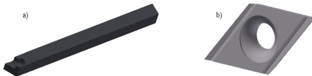
Рисунок 1. а) 3D Модель державки; б) 3D Модель режущей пластины
