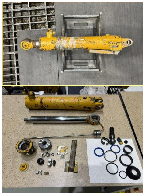
4-сурет. SC16M4 рульдік цилиндрінің жөндеуге келіп түскендегі көрінісі
