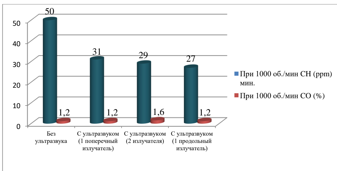
Рисунок 6. Диаграмма содержания СН и СО в выхлопном газе при 1000 оборотах коленчатого вала в минуту
