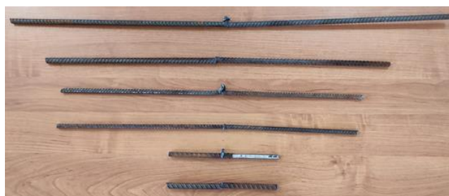
Рисунок 4. Некоторые арматурные стержни, соединенные сваркой трением
