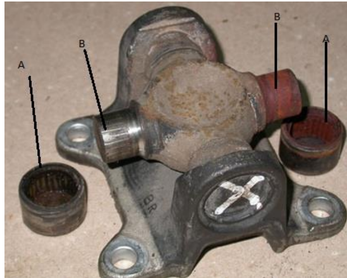
Сурет 3. Тозған бөлшектердің сыртқы түрі ("жалған бринелирлеу") мойынтірек түйіні А) - мойынтірек; В) - кресттер
