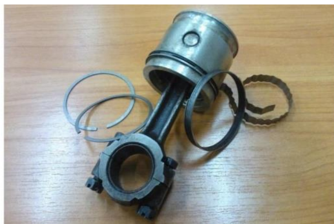
Сурет 3. Жаңа дизайндағы поршеньді және поршеньді сақина жинағы бар компрессордың шатун
