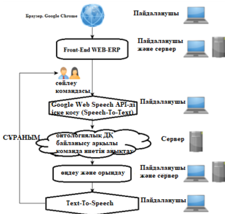
Сурет 1. Web-ERP интеграцияланған интеллектуалды виртуалды кеңесшінің жұмыс істеу архитектурасы
