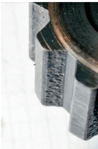
Рисунок 5. Износ шестерни насоса
