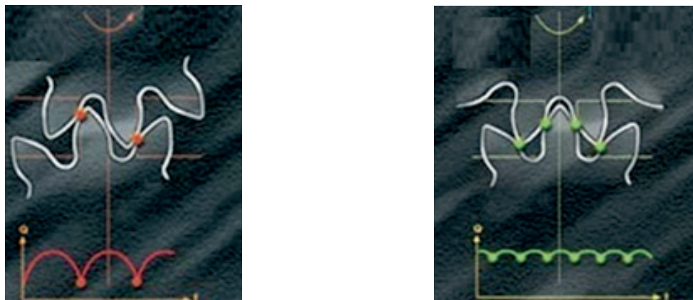
а) зазоры и пульсации в стандартном насосе б) зазоры и пульсации в насосе с меньшим зазором (большее согласование шестерен)
