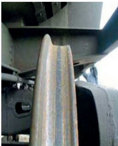
Сурет 1. Сырғанау бетінің табиғи тозуының негізгі түрлері: а) дөңгелектер; б) рельстер
