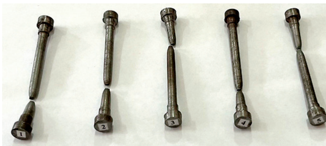
Рисунок 2. Испытанные образцы на растяжение
