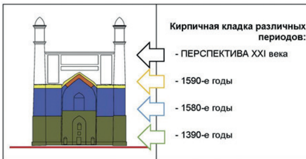
Рисунок 3. Расположение кирпичной кладки различных периодов в главном, юго-восточном фасаде мавзолея-ханака Ходжа Ахмеда Ясави – чертёж (1390-е годы; 1580-е годы; 1590-е годы; перспектива XXI в.).
