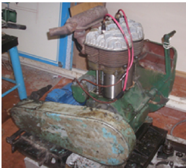
Сурет. 7. Жаңғыртылған қозғалтқыш базасында құрғақ поршеньді тығыздауды зерттеуге арналған тәжірибелік стенд УД-2М
