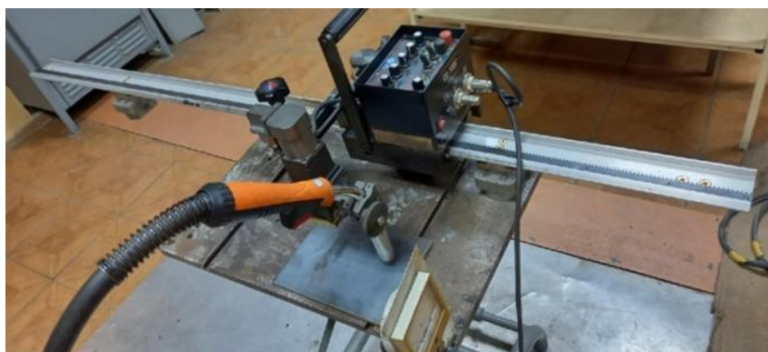
Рисунок 3. Общий вид используемой каретки с установленной сварочной горелкой
