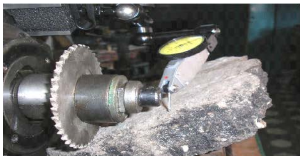
Рисунок 1. Процесс замера деформаций образца асфальтобетонного покрытия с помощью магнитной измерительной головки
