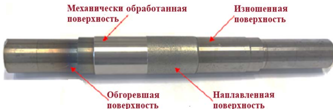
Рисунок 3. Восстановление изношенного вала
