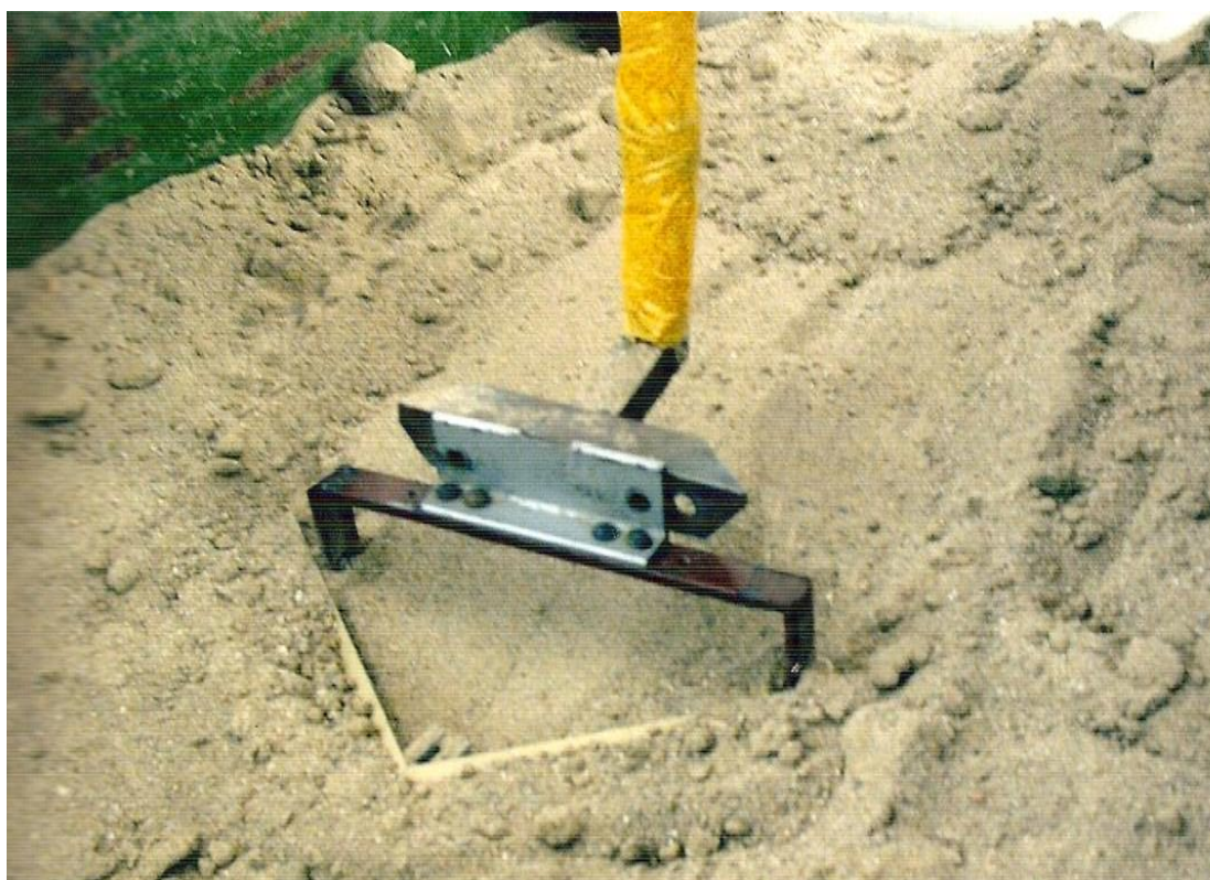
Рисунок 7. Физическая модель режущей кромки периметра ковша.
