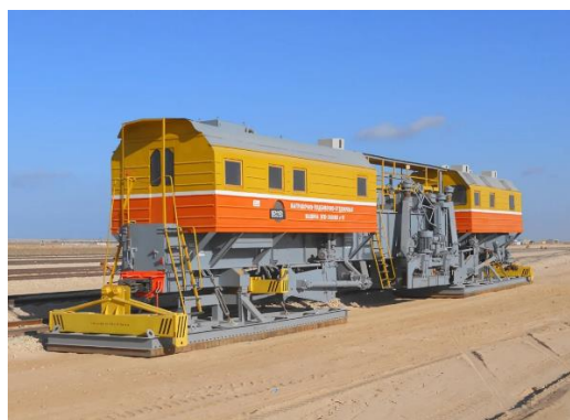
3-сурет. Түзету-ұру-әрлеу машинасы (ВПО-3000)
