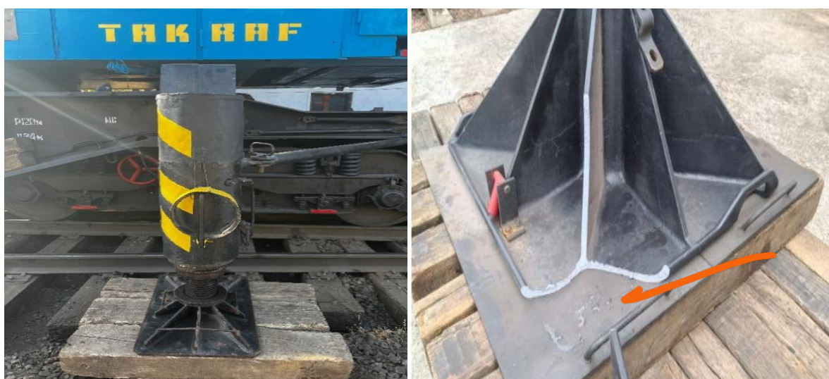
4-сурет. а) ЕДК-500 кранының аутригерінің жалпы көрінісі мен ақау түрі
