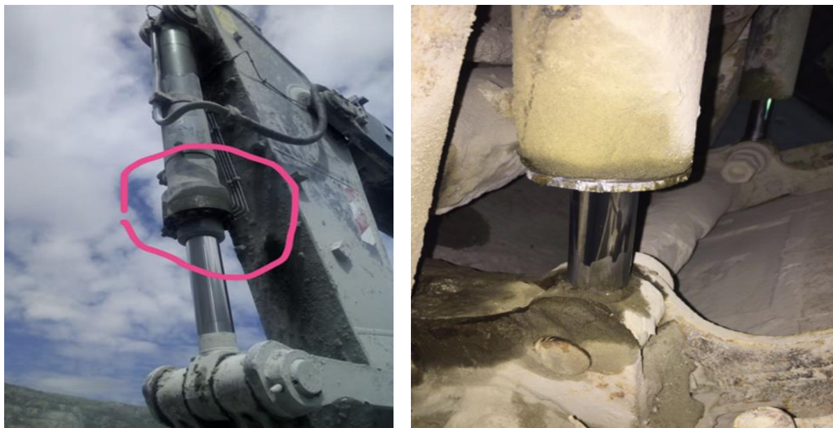
2-сурет. Цилиндр басының қақпағының астынан гидравликалық сұйықтықтың ағуы
