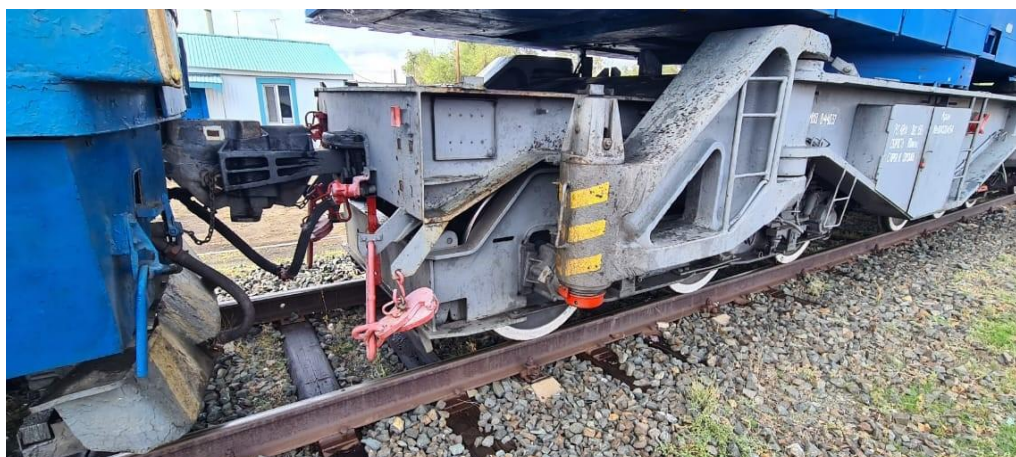
3-сурет. Темір жол кранының жүріс бөлігі
