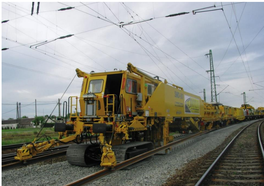
4-сурет. SMD-80 сериялы жолды жөндеу машинасы
