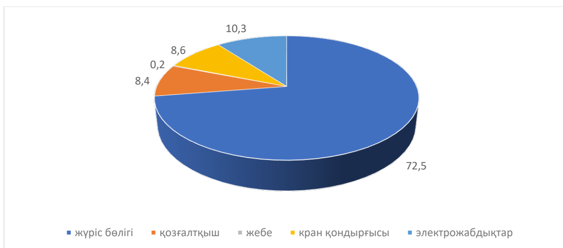
5-сурет. Теміржол краны ақауларының диаграммасы
