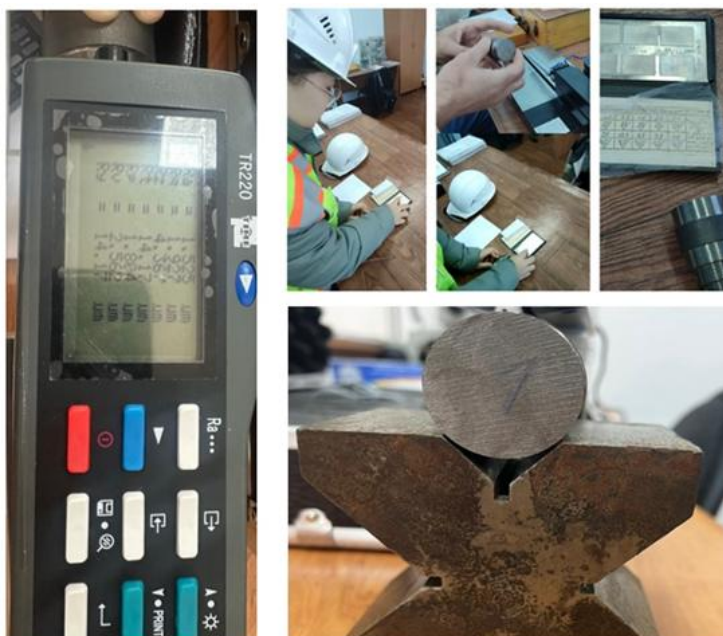
4-сурет. TR220 портативті өлшегіштегі беттің кедір-бұдырын өлшеу
