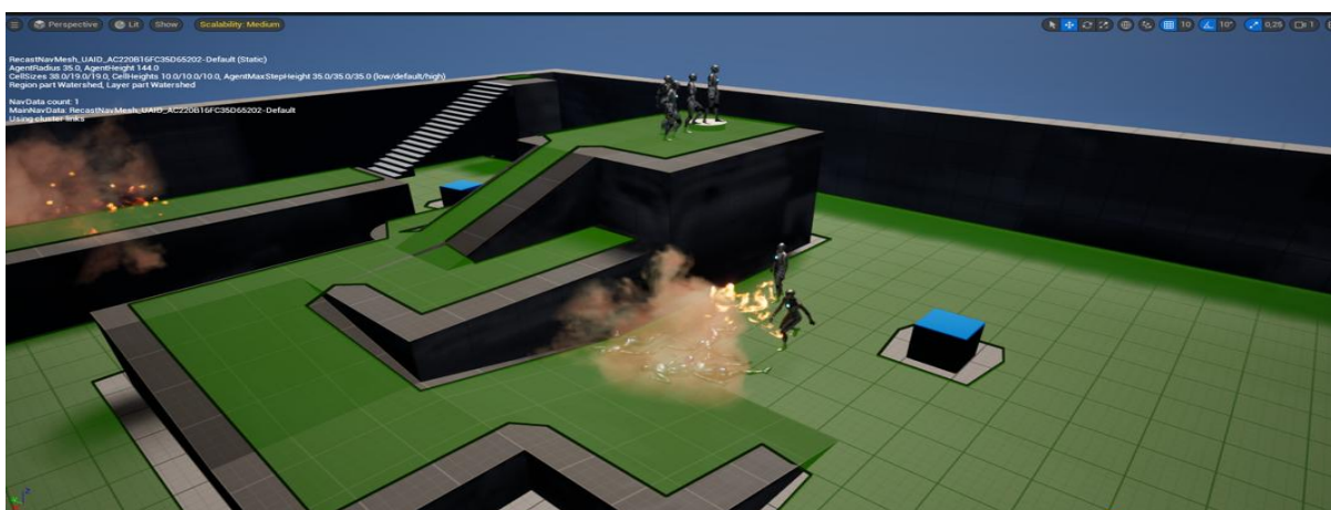
Рисунок 6. Поведение AI-агентов в условиях пожара. Визуализация реакции агентов на распространение огня в VR-среде, моделирующей процесс эвакуации. Принятие решений для поиска безопасного маршрута
