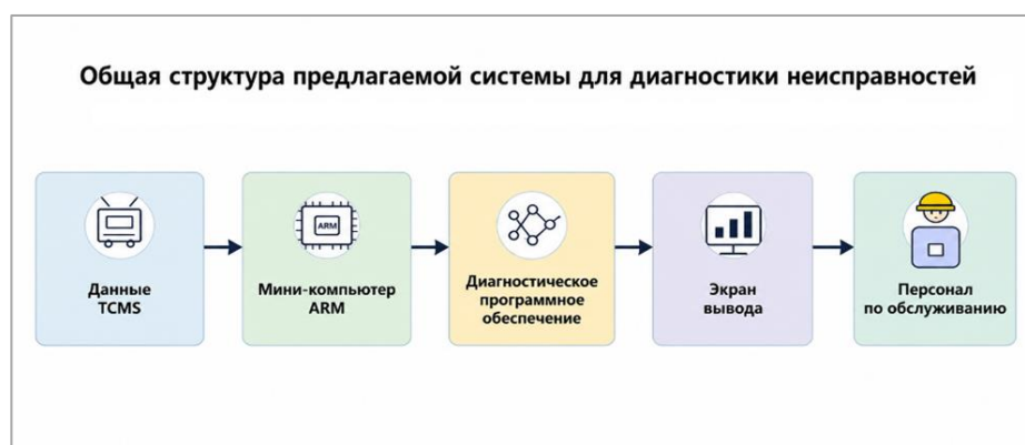
Рисунок 3. Общая структура предлагаемой системы для диагностики неисправностей
