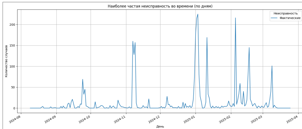
Рисунок 8. Ежедневное общее число ошибок в историческом экспорте TCMS до ACU-специфического моделирования
